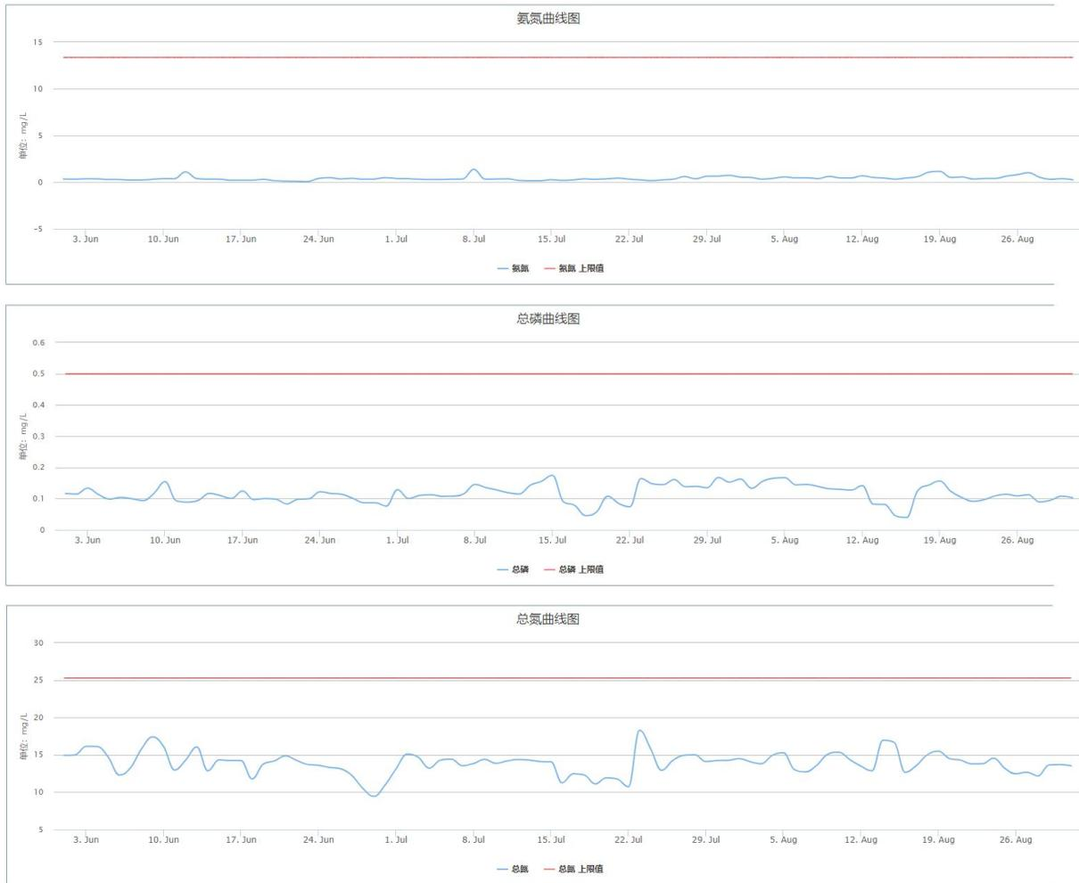
由上图可知，上虞污水处理厂工业废水处理工程尾水各类指标中 pH、COD、氨氮、总磷、总氮浓度均能满足排环境标准的要求。
